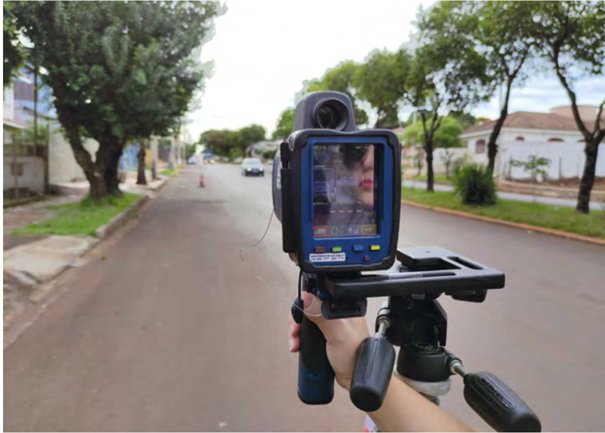
Radar móvel utilizado pela equipe do DMT em fiscalizações de velocidade nas vias urbanas de Santo Ângelo
