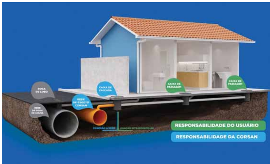
Ilustração elaborada pela Corsan para mostrar o modo correto de realizar a ligação de esgoto pluvial e cloacal
