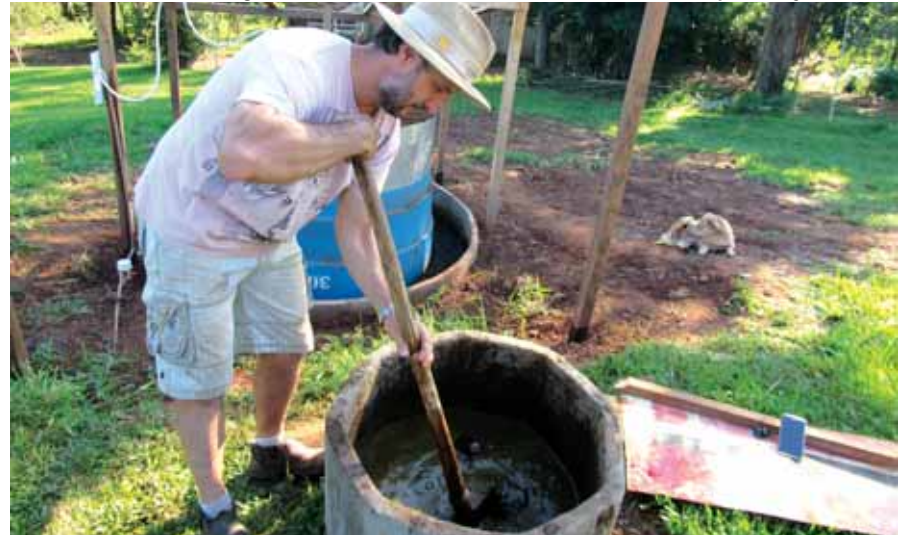
Itamar Marchi prepara a matéria prima do biodigestor (esterco e água na mesma proporção)
